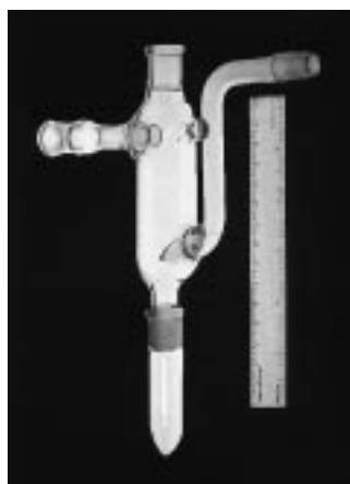
Abbildung 1. Apparatur zur Destillation geringer Mengen von 1a–c aus einer Hexadecanlösung. Lösungen von 1a–c können durch Zufügen des gewünschten Lösungsmittels zur Hexadecanlösung und anschließende Destillation erhalten werden. Das Lineal ist 15 cm lang.
